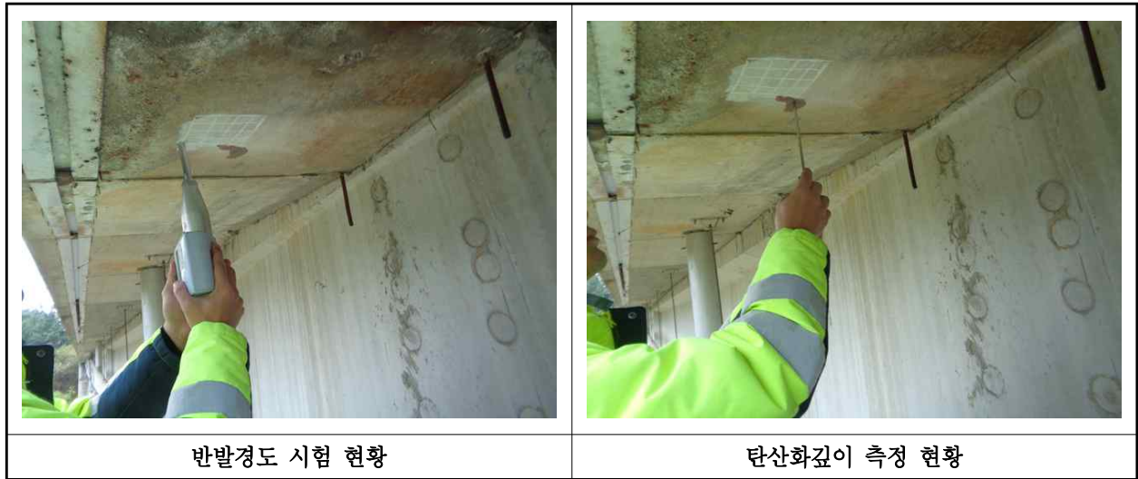
【사진 6.4.1】 콘크리트 내구성조사 현황
